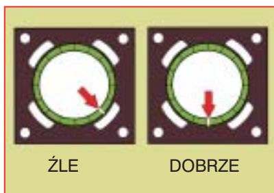
Rys. 1 Po odpowiednim docięciu izolacji umieścić ją w pustaku, tak by jej końce stykały się pośrodku pustaka.
