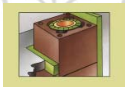
Rys. 5 Przy przejściach komina przez strop zachować odpowiednią dylatację w granicach 2 cm. Szczelinę wypełnić np. wełną mineralną.
